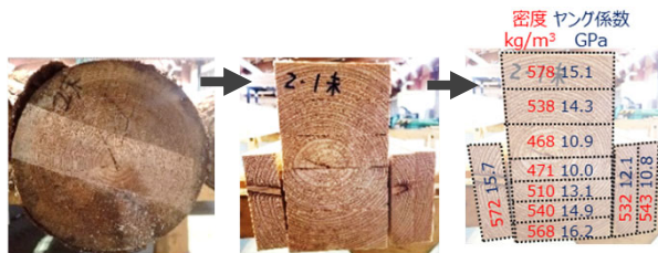
図1 カラマツ原木(φ30)と製材されたラミナ (丸太の外側からヤング係数・密度の高いラミナが得られる)
