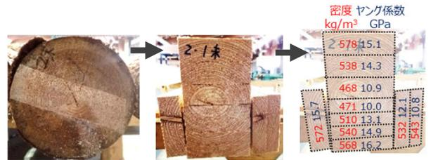
図1 カラマツ原木(φ30)と製材されたラミナ (丸太の外側からヤング係数・密度の高いラミナが得られる)
