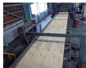
写真2 LVLの製造の様子
