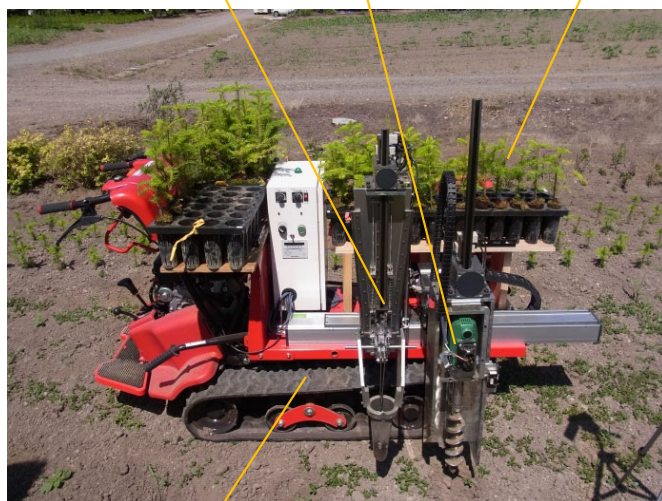
図3 開発した植栽機械
