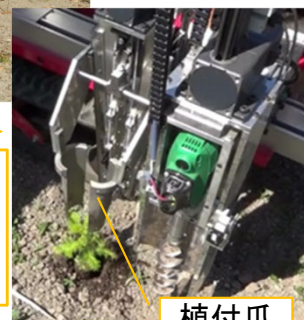
図2 開発した植栽ユニット 植付爪が開きながら上昇して苗を植え付けます。
