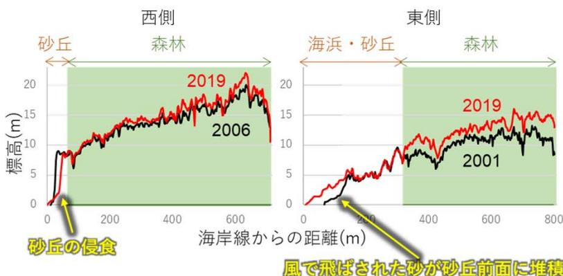
図-1. DSM差分解析から得られた地形と林冠高の変化。
