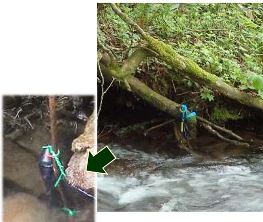
写真-1 水位計の設置状況
