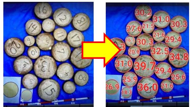
図-1 写真検知画像の一例(距離2mから撮影)
