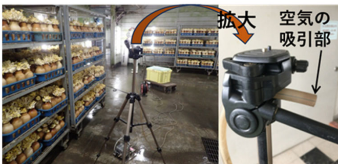
写真2 数千本規模の栽培試験の様子：右写真のエアサンプラーから空気を吸引し，空気中の孢子を含む浮遊物質を測定する
