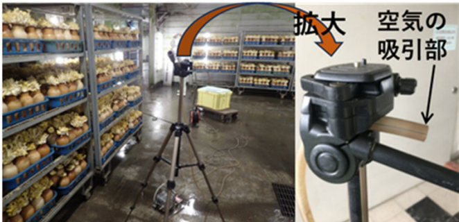
写真2 数千本規模の栽培試験の様子：右写真のエアサンプラーから空気を吸引し，空気中の胞子を含む浮遊物質を測定する
