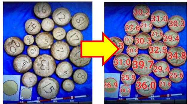
図-1 写真検知画像の一例(距離2mから撮影)
