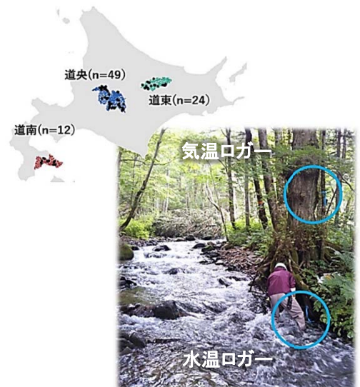
図-1 温度ロガーの設置流域および設置状況の例。
