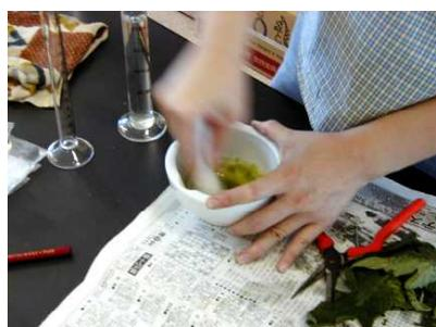
④ 葉柄を乳鉢に入れ、よくすりつぶし、蒸留水49mlを加え(50倍希釈)攪拌する。
