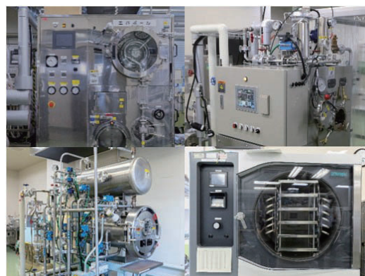
左上：遠心式薄膜真空蒸発装置 右上：短時間調理殺菌装置 左下：レトルト殺菌機 右下：真空凍結乾燥機
