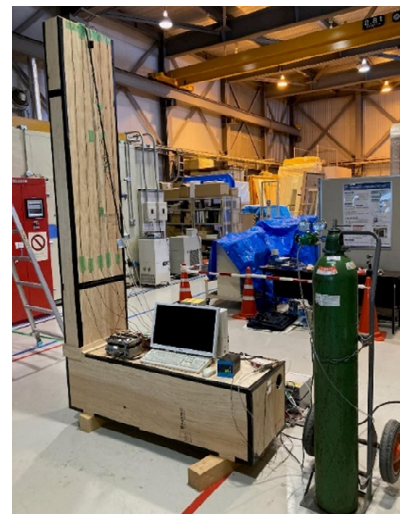
間仕切壁の気流量把握実験
