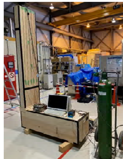
間仕切壁の気流量把握実験
