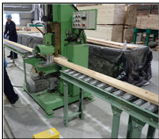
図4 ローラー型のインサイジング装置。 (宮内ら, 林産試験場報, 2022)
