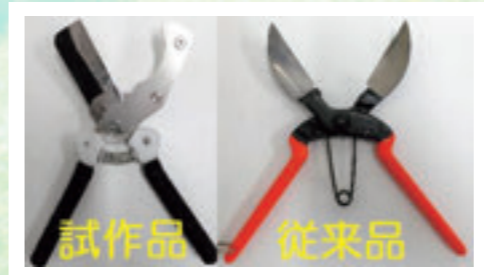
写真2 カボチャ用軸切りはさみの改良
