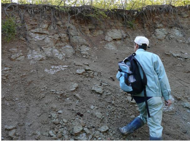
図 5-4 十勝火砕流堆積物の表層に発達する風化部。地表から深さ 5m 程度までは、風化により礫状となり、最上部は土壌化が進む。富良野市南布礼別。
