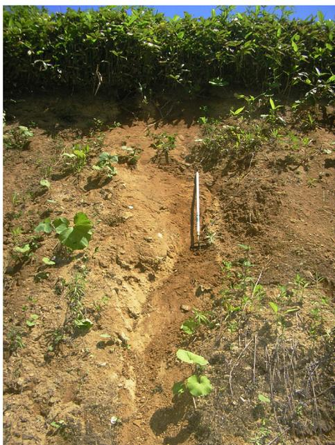
図 7-1 花こう岩分布域における、山麓緩斜面の表層地質の状況。マサ状の砂を主体とし、わずかに細礫サイズの角礫を混じえる砂質土。南富良野町富良野広域串内牧場。
