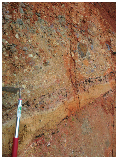
図 4-4 美深層の火砕質砂礫岩。安山岩～流紋岩の角礫～円礫と同質の基質からなり、赤色風化している。剣淵町荻分川北方。
