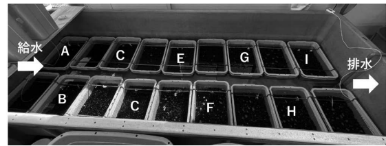
図3 容量3トンの水槽を使用した循環ろ過
