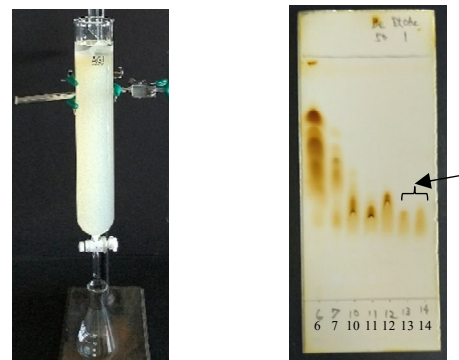
図5 シリカゲルカラムクロマトグラフィーによる精油成分の分離（左）、シリカゲル薄層クロマトグラフィーによる分離状況の確認（右）
