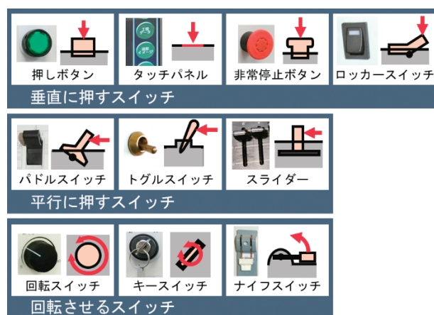
図1 検出対象のスイッチと操作部の概要
