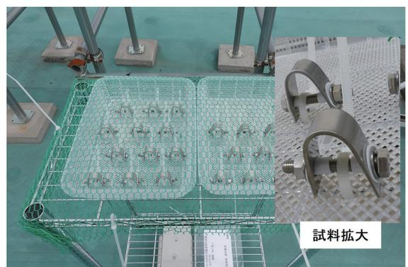
図6 暴露試料設置状況
