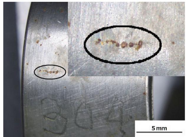
図23 SUS304鋭敏化材に発生した割れ
