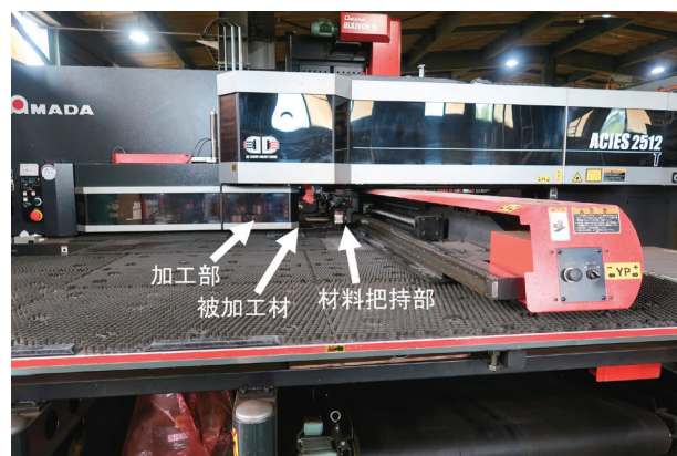
図27 実工場における検証実験の様子
