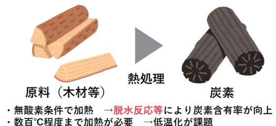
図1 一般的な多孔質炭素の製造方法
