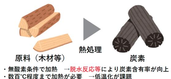
図1 一般的な多孔質炭素の製造方法
