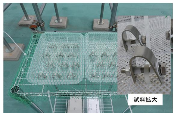
図6 暴露試料設置状況
