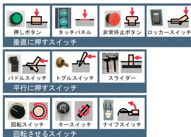
図1 検出対象のスイッチと操作部の概要
