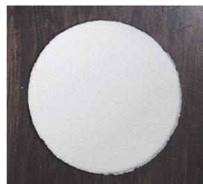
図1 熱プレス前の中間複合材のサンプルイメージ
