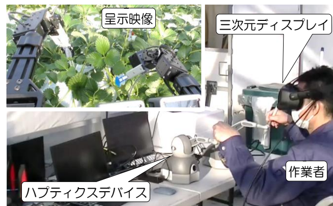
遠隔操作による作業の様子
