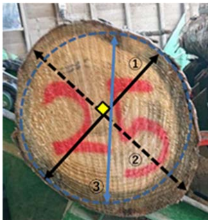
写真2 3種の径級検知の再定義 (丸太末口に書かれた数字は通し番号の25番)
