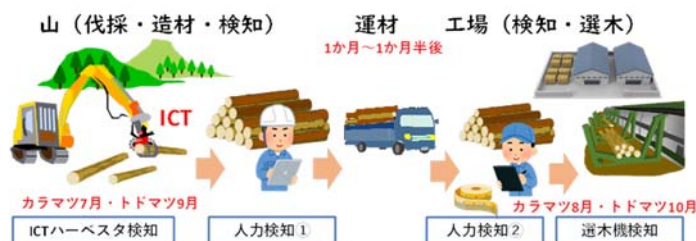
図 1 山から工場までの 3 種類の検知の流れ
