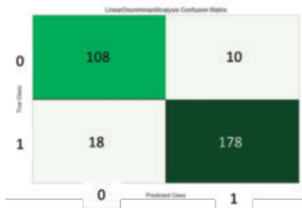
図 2-26 機械学習による推論モデルの混同行列 クラス名 0: 円形 1: 変形 正解率 91%
