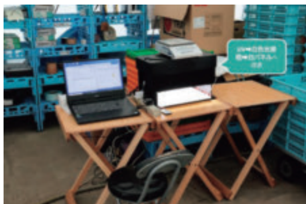
図 2-16 小規模生産施設に試験設置したシイタケ等級判別試作機
