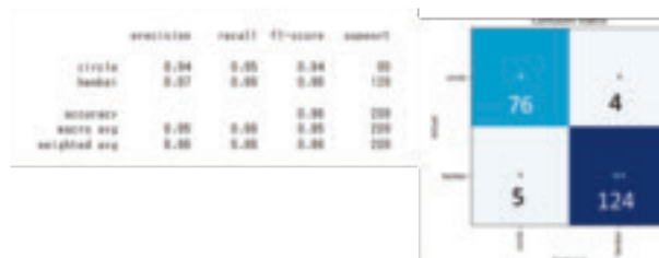
図 2-27 形状判別モデルの混同行列 正解率 96%
