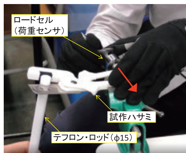
図 1-13 切断力測定試験の様子
