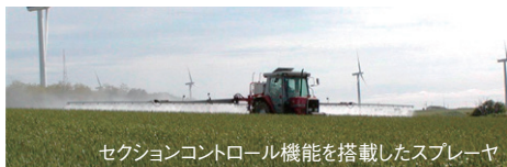
セクションコントロール機能を搭載したスプレーヤ
