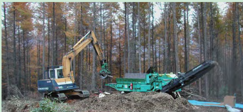
写真-2 林地残材のチップ化(左:グラップルローダ 右:移動式チップパ フルカワPC1600)
