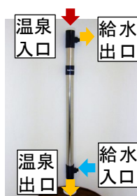
図 3 熱交換器の外観
