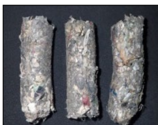
写真1 農廃プラを混合した燃料 農廃プラ混合比を20～50%で変え、燃料製造が可能であることを確認した。
