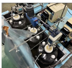
図1 混合メタン発酵リアクター
