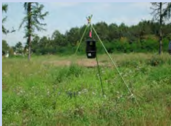
写真-1 集合フェロモンを取り付けたモニタリング・トラップ
