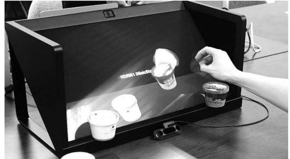
図 2 試作したビューワーソフト画面
