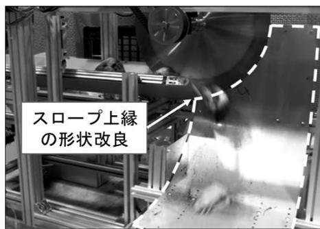
(b) 開発した機構：スロープ形状の改良で安定
