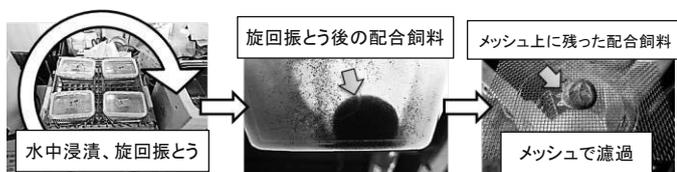
図2 簡易水中保形性試験の流れ
