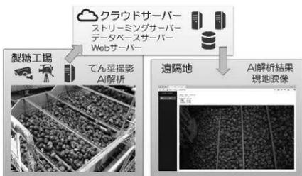
図1 遠隔モニタリングシステムの構築
