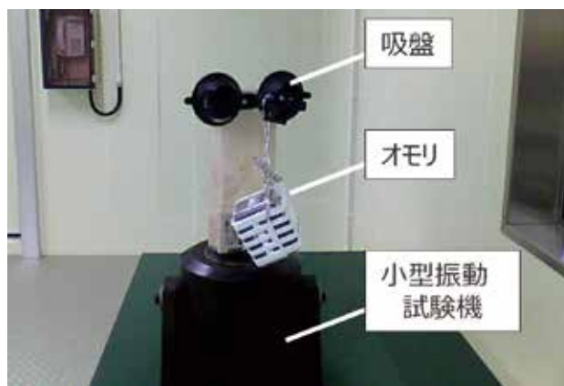
低温試験室内での耐振性評価試験の様子
