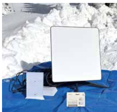
図2 衛星通信機器(Starlink社)を用いた通信試験
