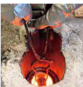
リサイクル金属 材料投入
