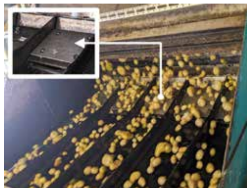
異物の衝突音を検出するための マイクを内蔵した金属板
