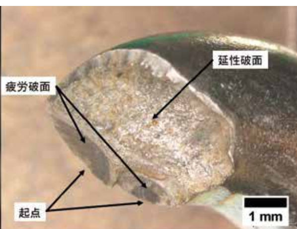
図2 ピアノ線製ばねの破面
