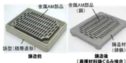
写真2 金属粉末積層造形物の錆ぐるみ接合による一体化技術
