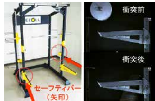
高速度カメラによるセーフティバーの 衝突変形挙動の観察
