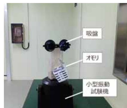
低温試験室内での耐振性評価試験
