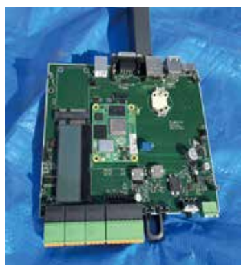
図1 試作した遠隔監視用データロガー装置
