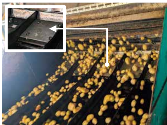
異物の衝突音を検出するための マイクを内蔵した金属板
