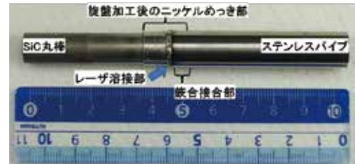
めっき層とSUS304ステンレス鋼の パイプを嵌合したレーザ溶接材
