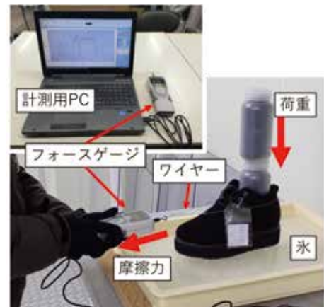
摩擦力測定試験の様子
