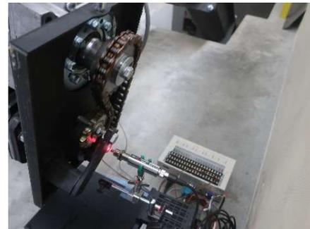
写真 3 光電式回転検出器による測定の様子
