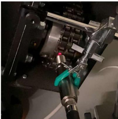
写真2 光電式回転検出器による測定の様子
