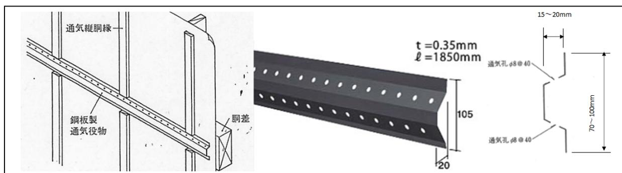
図1-7 準耐火設計指針<sup>5)</sup>に示されている有孔鋼板製の通気役物(ファイヤーストップ)
