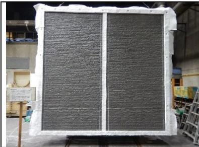
試験体加熱面 (試験前)
