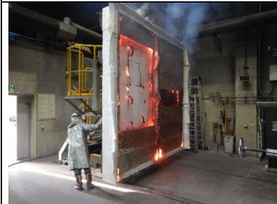
試験体加熱面 (脱炉後)
