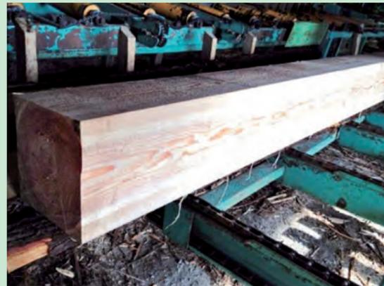
写真-2 スギ大径木から製材した無垢材
