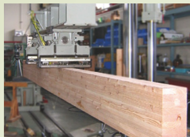
実大材の曲げ強度試験
