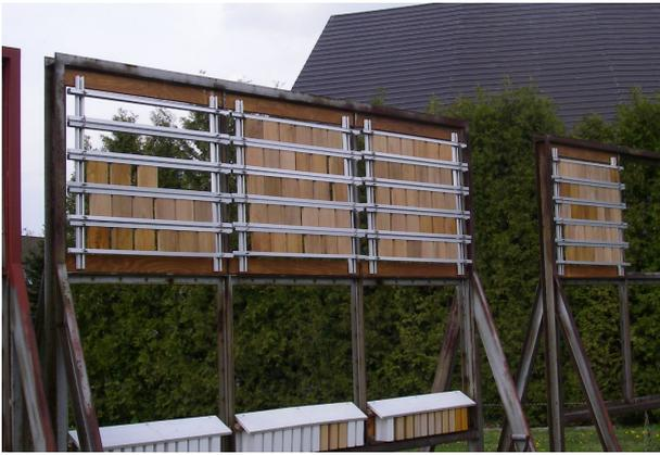
写真2 暴露開始時の試験体の状態 (旭川)
