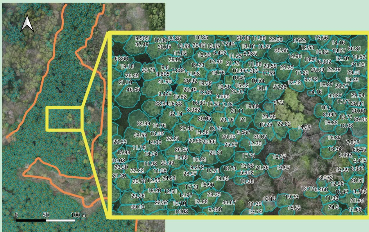
図-1 UAV 空撮で作成されたオルソ画像上のトドマツを単木計測 AI で分類した結果
