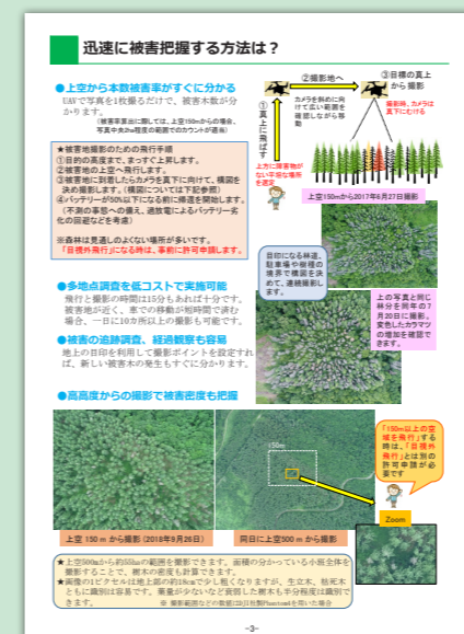
図-3 ドローンを活用した被害把握法
