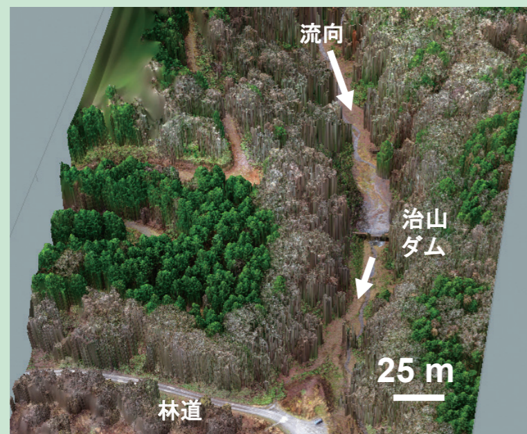
図-1 UAVを用いた空中写真測量により構築した3次元モデル
