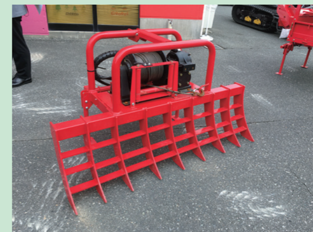
写真-4 残材除去用レーキアタッチメント
