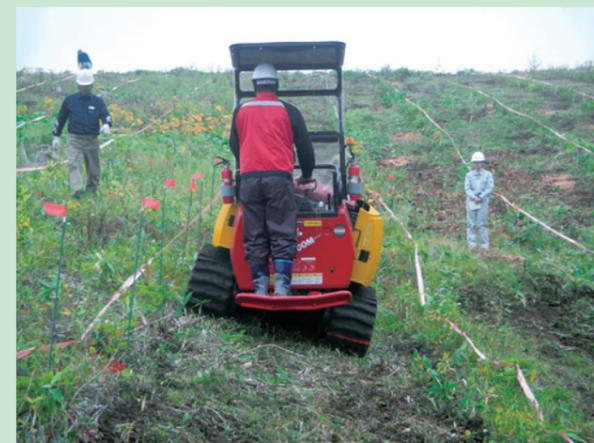
写真-2 横傾斜でも作業可能(2018年10月)
