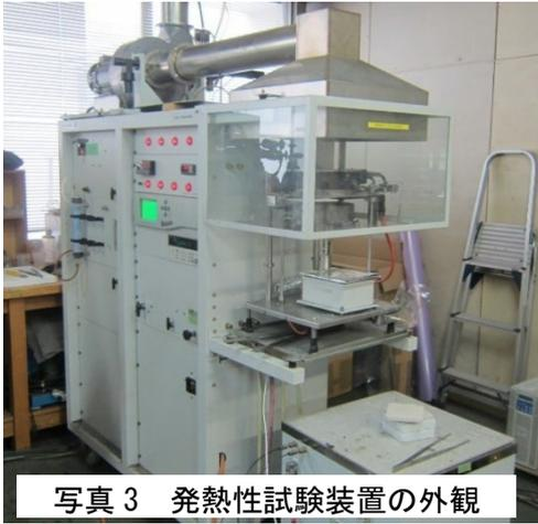
写真3 発熱性試験装置の外観
