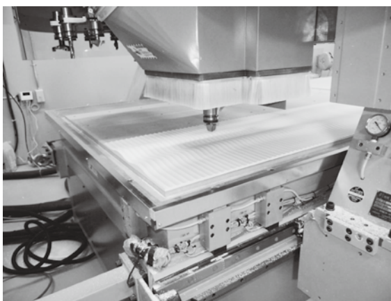
N C加工機によるケイカル板加工状況
