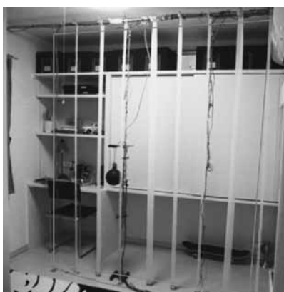
住宅における冷房運転時の室内温度分布
