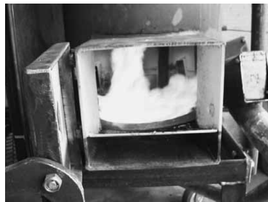
廃不凍液の燃焼状況
