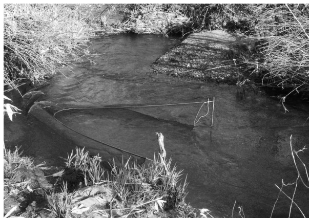
図2 サクラ川でのカラフトマス降河稚魚の採集に用いたふくべ網の設置状況
